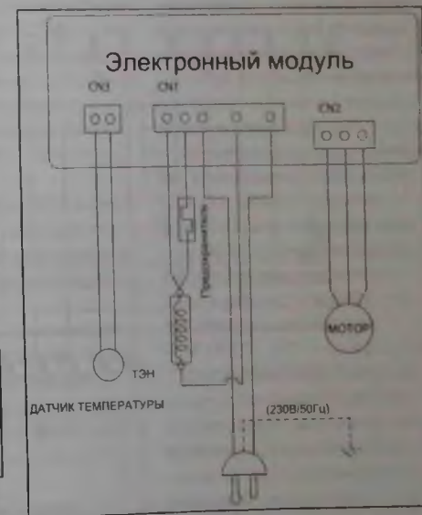
Рис. 4. Схема подключения внешних узлов к ЭМ
