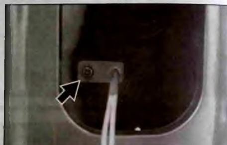
Рис. 18. Замена температурного датчика
