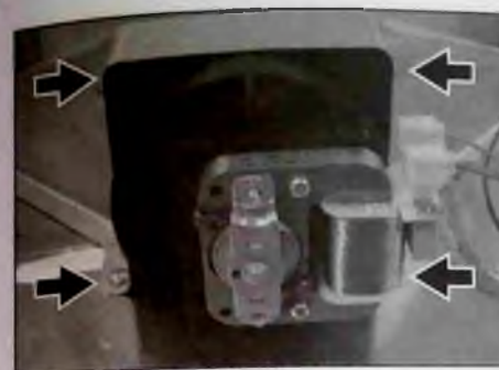
Рис. 13а. Извлечение электродвигателя вентилятора охлаждения
