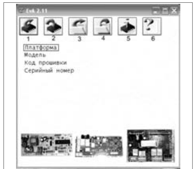
Рис. 3. Внешний вид главного меню программы EVA, где цифрами обозначены функциональные кнопки: 1 — «Чтение прошивки», 2 — «Запись выбранной прошивки», 3 — «Выбор прошивки», 4 — «Запись считанной прошивки в ПК», 5 — «Настройки» (выбор платформы, COM-порта, значения задержки), 6 — «Информация о программе»
