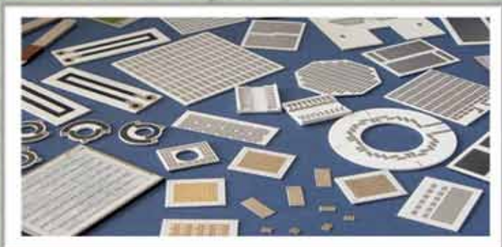
Виготовлення радіоелектронних компонентів на основі керамічної та товстоплівкової технологій
